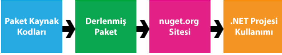
Şekil 6.2: Nuget paketleri oluşturma ve kullanma şeması
